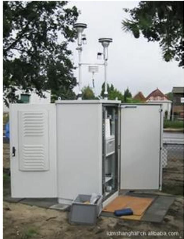
**【产品简介】** BAM-1020粒子监测仪，METONE的BAM-1020粒子测量仪通过了美国环保局的认证（EQPM-0798-122），他作为一种与测量PM10相同的方法，它采用了BETA射线衰减的原理，而且在英国、韩国和中国自动监测和记录PM10浓度应用领域中，在也获得了相应的证书。 BAM-1020可以通过装备PM2.5采样口来自动监测更小的粒子物质，而且可以被设置用来监测TSP（总悬浮颗粒物）。 BAM-1020的时证设计可以为用户提供更高的可靠性及性能，这种设计可以降低在日程操作中维护和维修费用，而且可以最大限度的节省人力。
